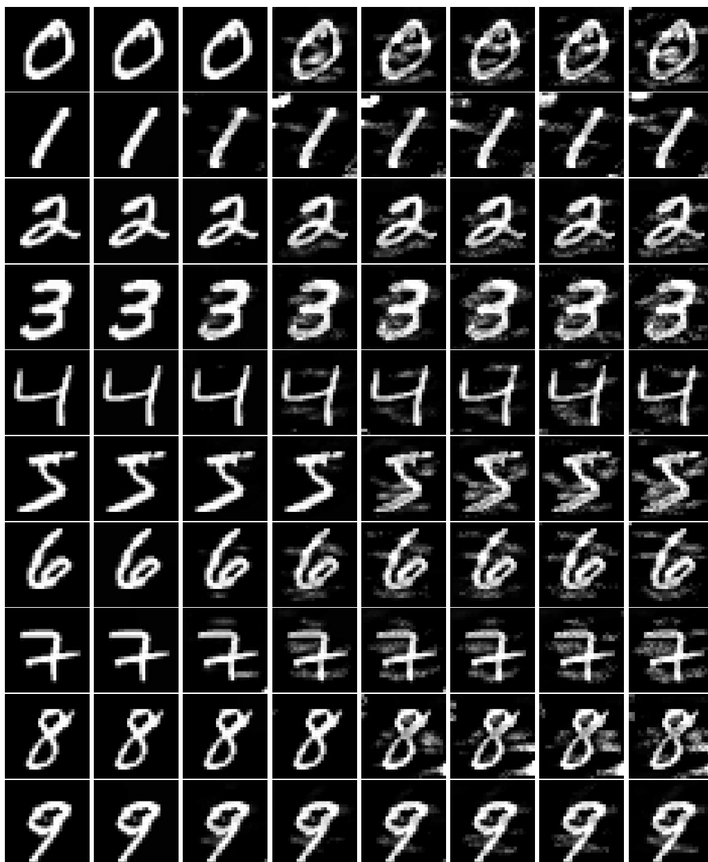
Obrázek 6.4: Vzorky generované CW útokem za použití metriky vizuální podobnosti DSSIM s velikostí výpočetního podokna 10; v řádku po řadě původní benigní vzorek, dále vzorky vygenerované s rostoucí hodnotou parametru \lambda
