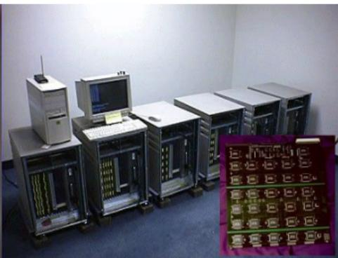
deep crack v celé své kráse (zleva): ASIC čip, deska osázená ASIC čipy, celé zařízení: 6 skříní s deskami a řídící PC.
