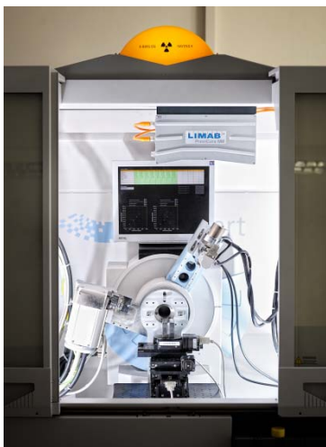
Obrázek 1. Difraktometr X'Pert PRO MPD vybaven polohovacím systémem se šesti stupni volnosti a určením polohy povrchu s přesností 5 \mu\text{m} .
